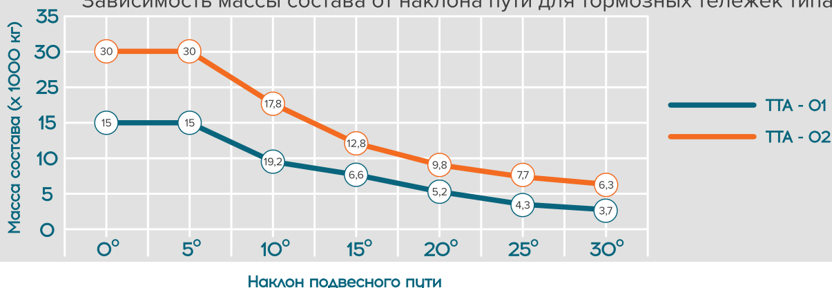
Зависимость массы состава от наклона пути для тормозных тележек типа ТТА
