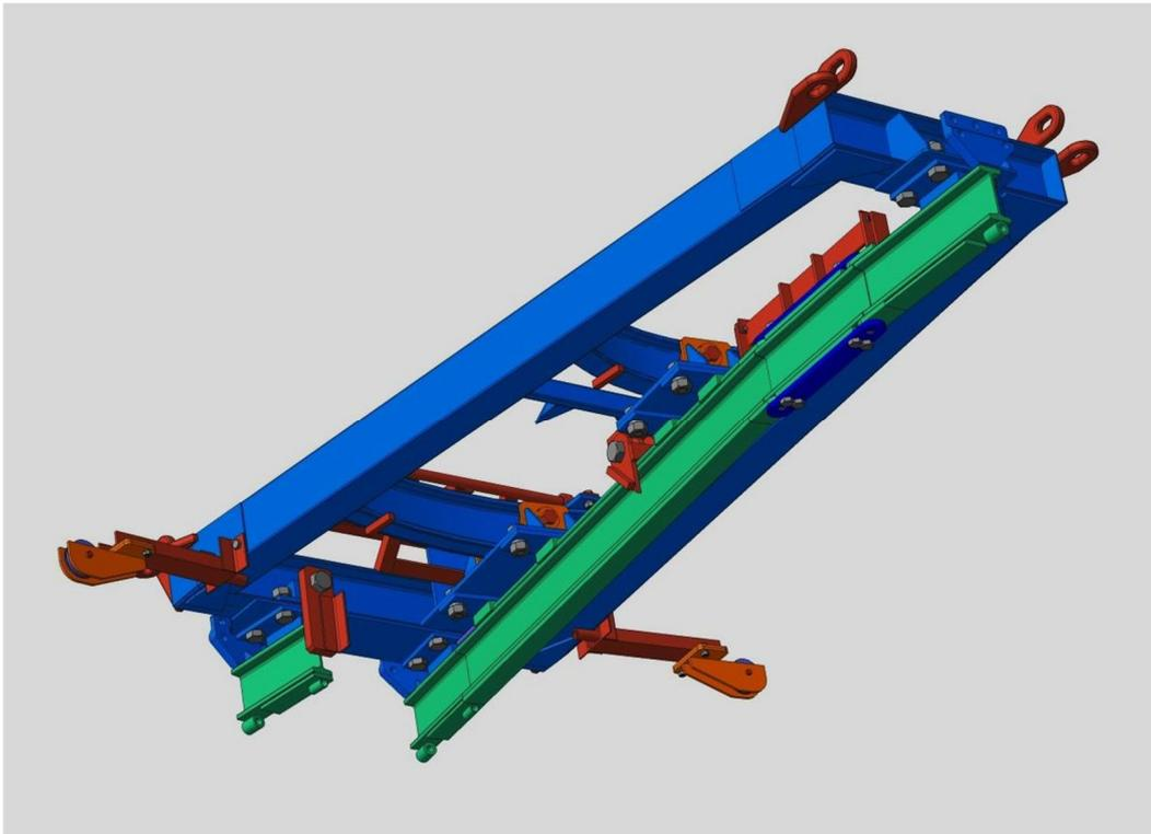
2. **Обзор конструкции.** Основу конструкции составляет трапециевидная *рама*, выполнена из профильной трубы прямоугольного сечения, на ней закреплены с помощью болтового соединения входной и выходные рельсы (левый и правый), поперечно внутри рамы установлены две *опоры*, *выполненные из профиля ДП-155*, которые распределяют нагрузку от направляющего рельса на всю раму
