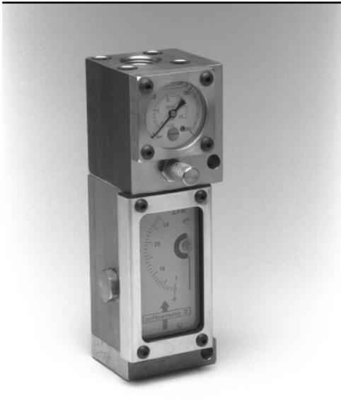
Датчик расхода и давления показывает объем потока и давление системы в жидкостных трубопроводах. Стопорный клапан также используется для снижения гидравлической пульсации в различных условиях таким образом, что в результате достигается устойчивая индикация стрелки.
